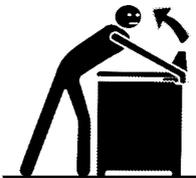
Ne pas faire fonctionner l'appareil sans un dispositif anti-basculement en place et enclenché.
